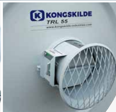
Fördergebläse TRL 55 mit Schieber zur automatischen Regulierung der Luftmenge.
