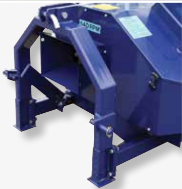
Dreipunktaufhängung für Schlepperantrieb.
