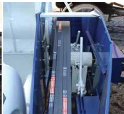
Riemen spannen ohne Werkzeug, nur für den Zugang zu den Riemen wird Werkzeug benötigt.
