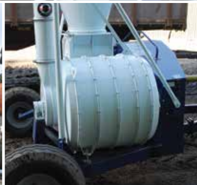
Starkes Gebläse mit bis zu vier Stufen für eine hohe Förderleistung.
