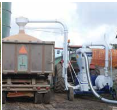
Die Verladeausrüstung der TR-Modelle für einfache Verladung von LKWs und Anhängern.
