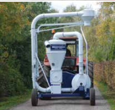
Gebläse mit Verladeausrüstung in Position für Straßenverkehr.
