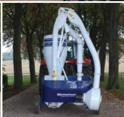
Hydraulisch in die Förderposition gefahrene Verladeausrüstung.
