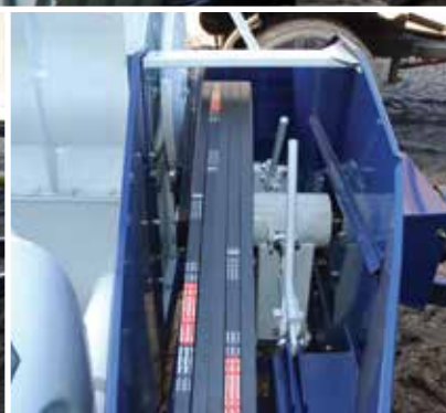
Remmene kan strammes uden brug af værktøj, dog kræves der værktøj for at få adgang til remmene.
