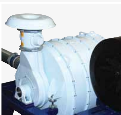
Automatisk luftregulering på TRL 1000. Spjældet lukkes automatisk under opstart.
