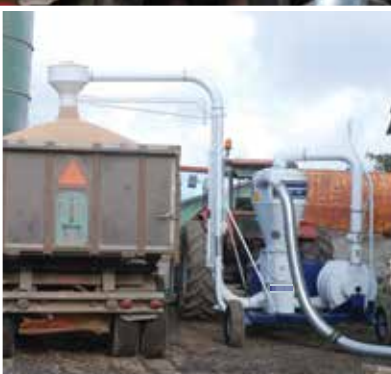
SUC TR-modellernes læseudstyr er særdeles velegnet til læsning af vogne og lastbiler.
