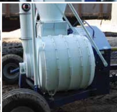
Kraftig blæser med op til 4 trin giver stor transportydelse.
