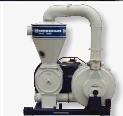
3-trins blæser på SUC 500T giver højt tryk til transport af korn.
