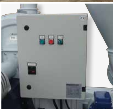
Styreskab til automatisk start/stop af motor.
