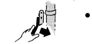
Verrouiller le cyclone en utilisant le dispositif d'arrêt (1).
