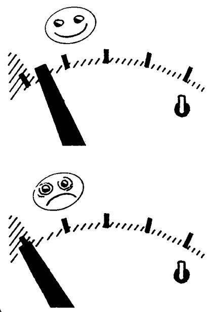
Spjældet på sugehovedet skal give den rigtige balance mellem luft og korn.
