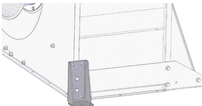
Należy upewnić się, że wentylator jest zainstalowany w sposób chroniący przed upadkami i przewróceniem. Prosimy upewnić się, że wentylator jest zainstalowana w sposób umożliwiający łatwy dostęp w celu wykonywania czynności obsługowych i konserwacyjnych. Wentylator musi być zainstalowany na stabilnej powierzchni, która jest równa i pozioma.
