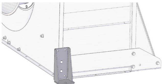
Sørg for at blæseren er installeret, så den er sikret mod nedstyrning og væltning. Vær opmærksom på at blæseren opstilles, så der er let adgang til betjening og vedligeholdelse. Blæseren skal opstilles på et stabilt underlag, som er plant og vandret.
